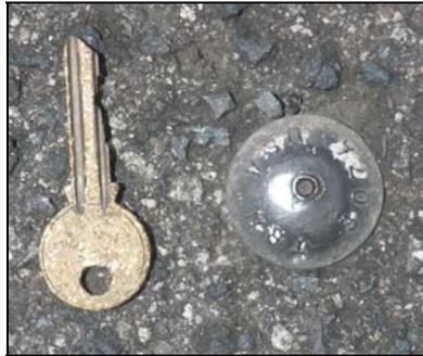
**Figura 1** Se muestra foto de la estación de control descrita como "Steel Bold" designado como M-10 con coordenadas igual a Y=64,491.3058 metros; X=199,547.3082 metros.
